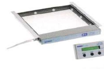
Misurato: tramite camera di ionizzazione nel fascio a livello del collimatore
